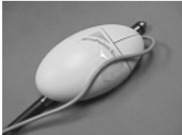
ペン型マウスの代わりに、加速度センサーやジャイロのような変位検出装置を利用することもできます。図 2 は、Gyration のジャイロ内蔵マウス Gyropoint<sup>1</sup> とペン型バーコード・リーダーを一体化した FieldMouse#2 です。Gyropoint は半導体振動型ジャイロスコープを内蔵しており、机のない場所でもマウスを使ったプレゼンテーションなどがおこなえるように工夫されています。
