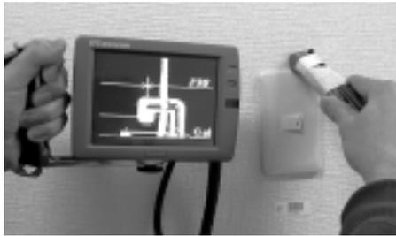
壁に向かう線の上を FieldMouse でなぞることによって信号の流れを表現します。線の上をなぞると FieldMouse は自動的にバーコードを認識するので、そのときの FieldMouse の移動方向からデータの発信側と受信側が確実に指定されることとなります。このような方法を使えば、各 AV 機器に番号や名前を付ける必要がなく、機器の操作も分かりやすくなるのではないのでしょうか。
