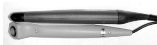
図1. FieldMouse の例. 機械式ペンマウスとバーコードリーダの組み合わせ.
