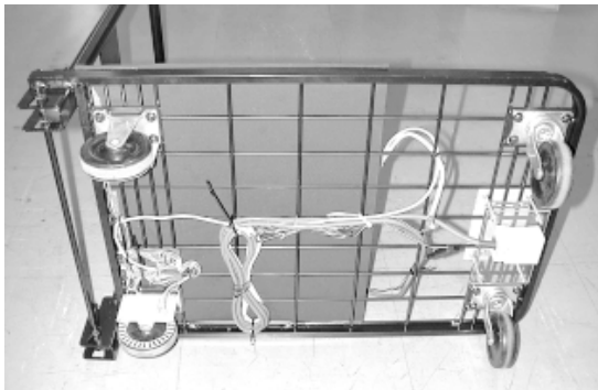
図 16 カートの底面．後輪(左)の回転を測定する．また先頭部分(右)にはRFIDリーダが取り付けられ、床の上のID板を読みとる．
