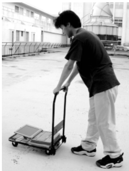
図15. Virtual Glassboat. カートに搭載されたコンピュータ画面が、移動方向と逆にスクロールする。
