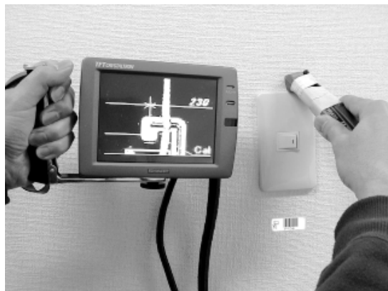
図 11. Scroll Browser で壁の中の配線を閲覧している様子 .
