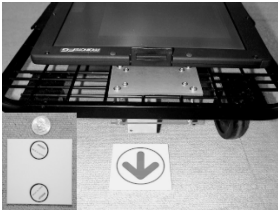
図 17 ID板．裏面(左下)に2個のRFIDタグが埋め込まれている．これを連続して読むことで、カートの絶対位置と方向を決定する．
