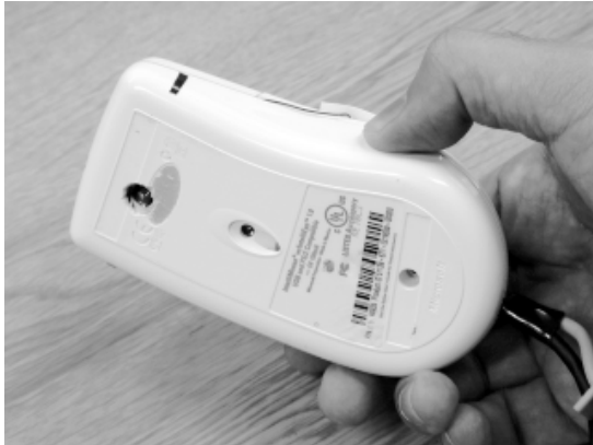
図2. FieldMouseの例．光学式マウスの内部にバーコードリーダーを組み込んだ．
